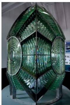
Fresnel lencsés optika és a reflektort mozgató szerkezet [7, 8]
