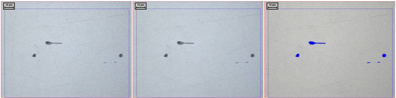
3. ábra Nem fémes zárványokról készített fémmikroszkópos felvételek
