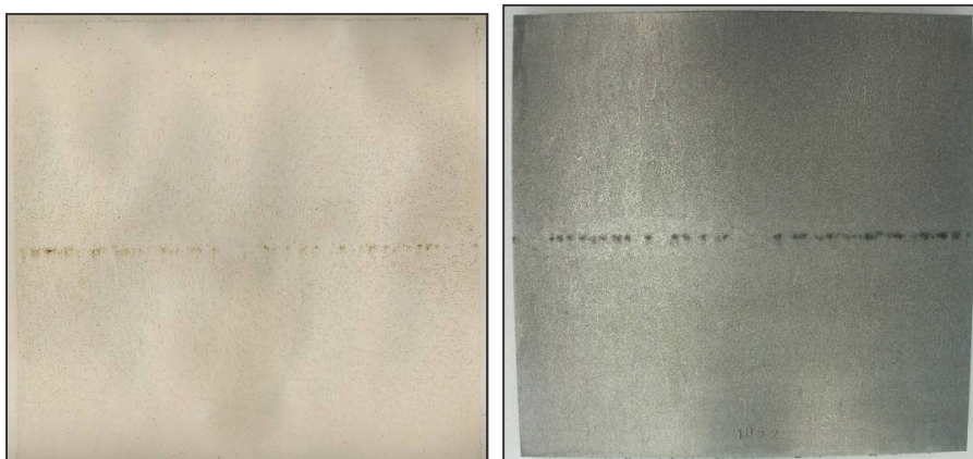
1. ábra Brammaszelet Baumann-lenyomata, illetve makroszöveve
